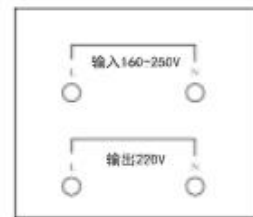
图4: 单相MPS-SL-5/30KVA接线图
