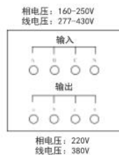
图5: 三相MPS-TL-20/100KVA接线图
